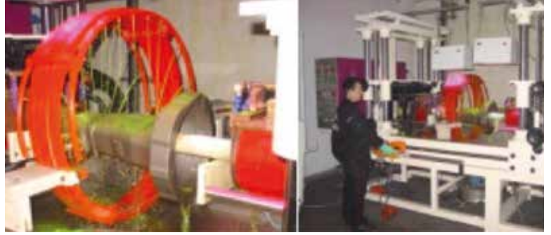
Şekil 10: Universal Manyetik Parçacık Test Cihazının Görüntüleri [4]
