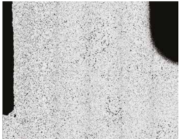
Elkem Lamet® ferrosilisyum magnezyum alaşımı kullanılarak tretmana sokulan metalde bu porozitenin tamamen giderildiği görülmektedir
